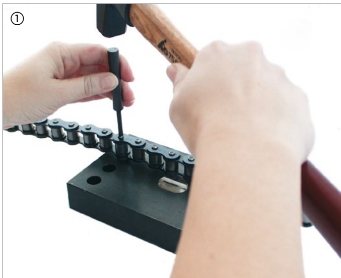
Kettenglied mit glattem Bolzen Chain with parallel bearing pin
